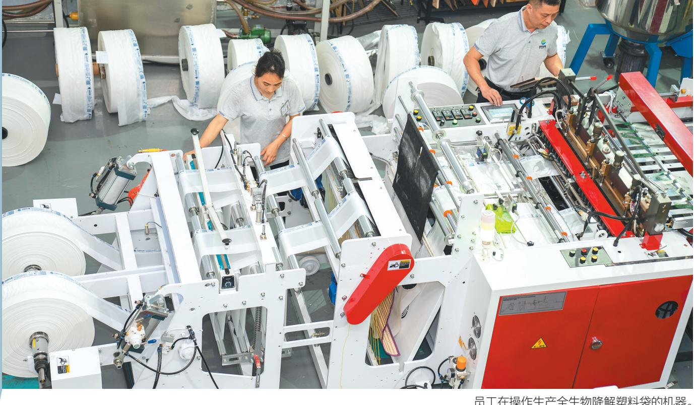
员工在操作生产全生物降解塑料袋的机器。
