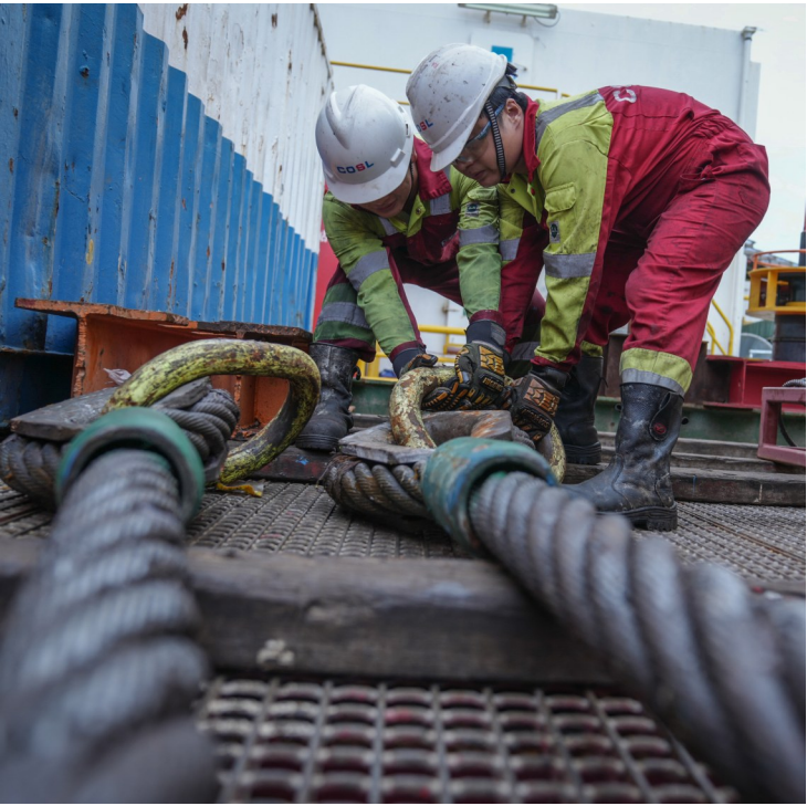
甲板班组人员正在挪动采油树吊装专用的钢丝绳，一条钢丝绳足足有一吨重，需要两个人才能挪动。
