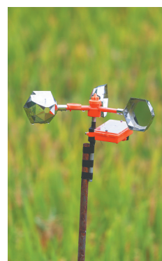
能发出多种声音并且可以多面反光的现代化驱鸟器。
