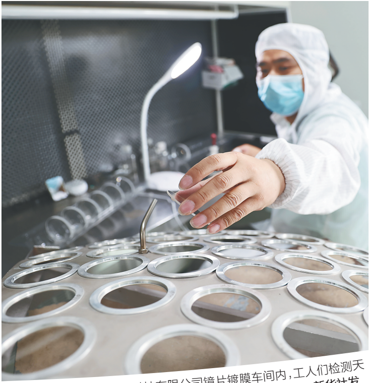
在江苏如皋一家光电科技有限公司镜片镀膜车间内,工人们检测天文望远镜镜片。 新华社发
