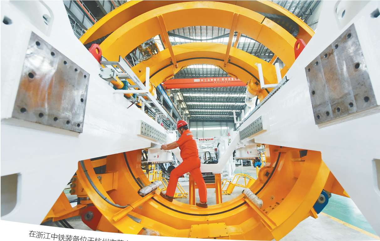
在浙江中铁装备位于杭州市萧山区的盾构机生产基地,工人安装新型盾构机的部件。 新华社发
