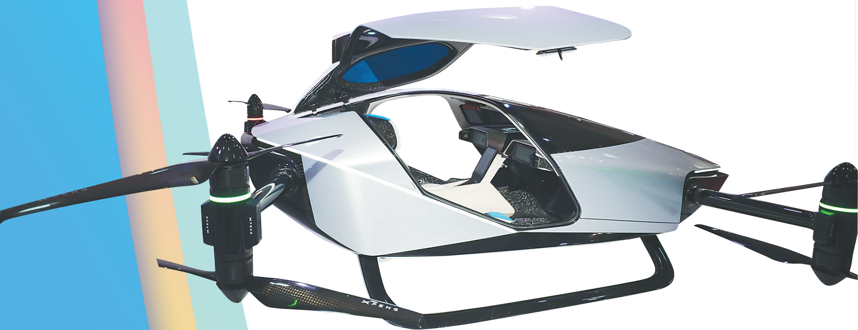
第二届消博会上展出的小鹏旅航者X2飞行汽车,空机重量560公斤,有效载重200公斤,续航时间35分钟,飞行高度1000米以下,最大飞行速度130公里/小时。 本报记者 张杰 摄
