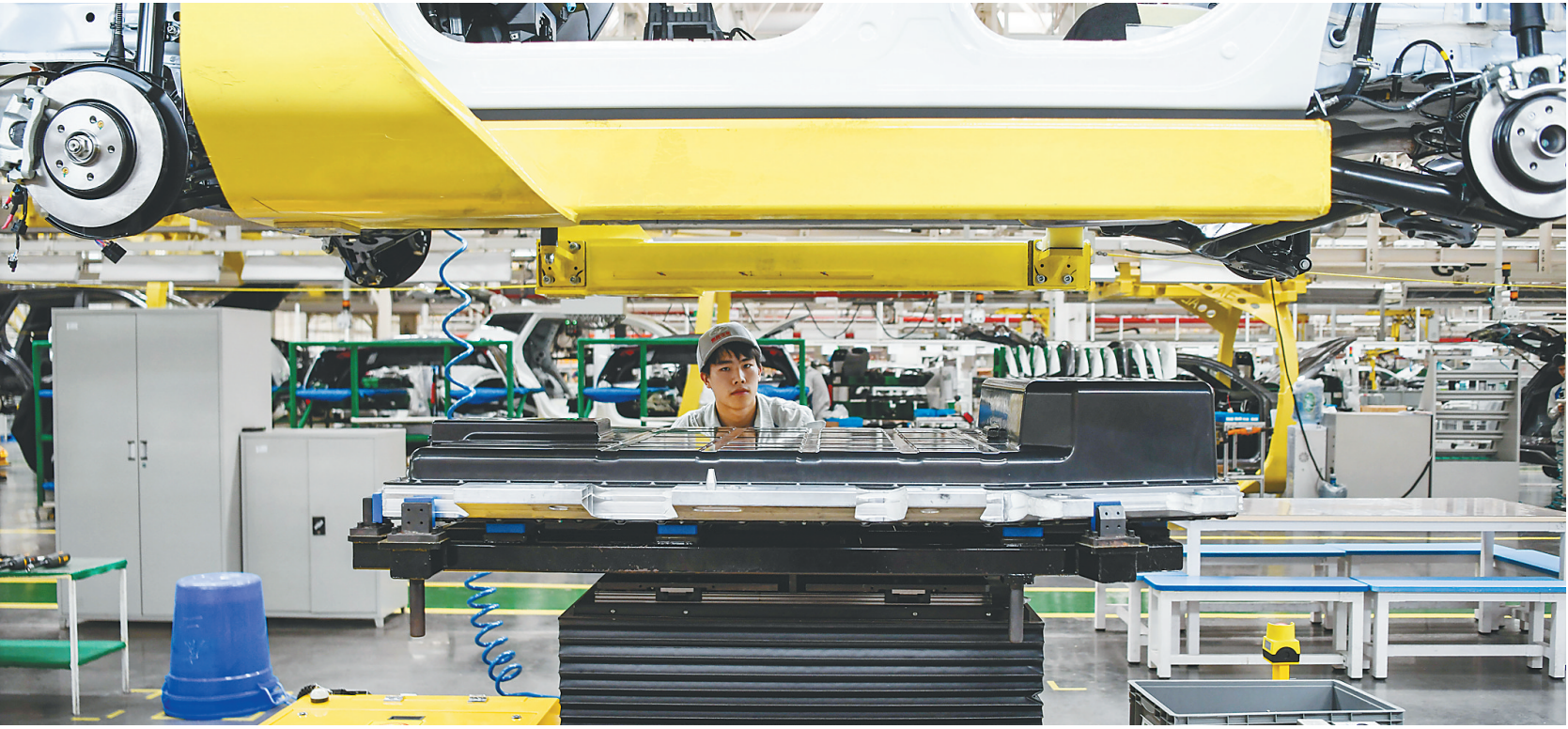
在四川省宜宾市凯翼汽车有限公司，技术人员在生产线上安装新能源汽车的动力电池。
