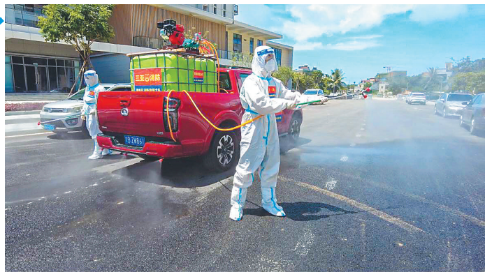
三亚市消防救援支队崖州大队队员在使用由皮卡车改装成的消杀车开展路面消杀作业。这种消杀车有9个喷头,作业效率高。 海南日报记者 武威 通讯员 莫文彬 摄
