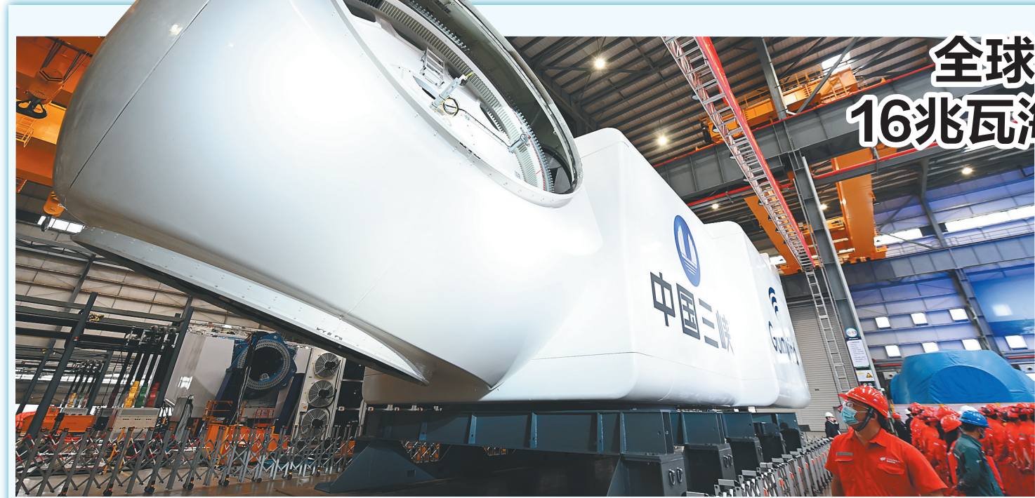
图为11月23日在福建三峡海上风电国际产业园下线的16兆瓦海上风电机组。新华社发
