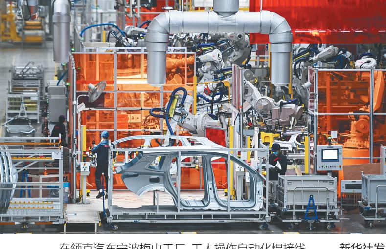
在领克汽车宁波梅山工厂，工人操作自动化焊接线。新华社发
