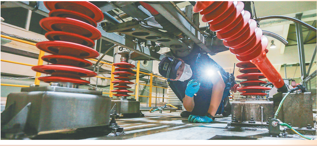
凌晨时分，城市已进入梦乡，中国最南端的动车所——海南铁路海口车辆轮渡段三亚动车所检修库仍灯光通明，青年机械师们还在为动车进行“体检”，为春运安全保驾护航。 上图：近日，机械师们正在对一组动车进行检修。 下图：机械师王新雨匍匐在受电弓与车顶棚之间，拿着钢直尺测量碳滑条剩余厚度。 本报记者 王程龙 通讯员 李必政 杨睿 图/文
