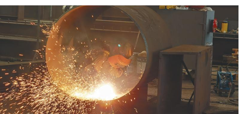
在华金钢构生产车间内,电焊工人在焊接筒形钢构件。
