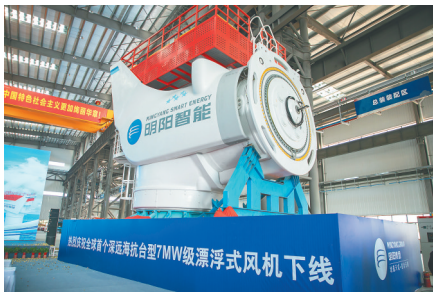
7MW级抗台风漂浮式风机。通讯员 赵茜 摄
