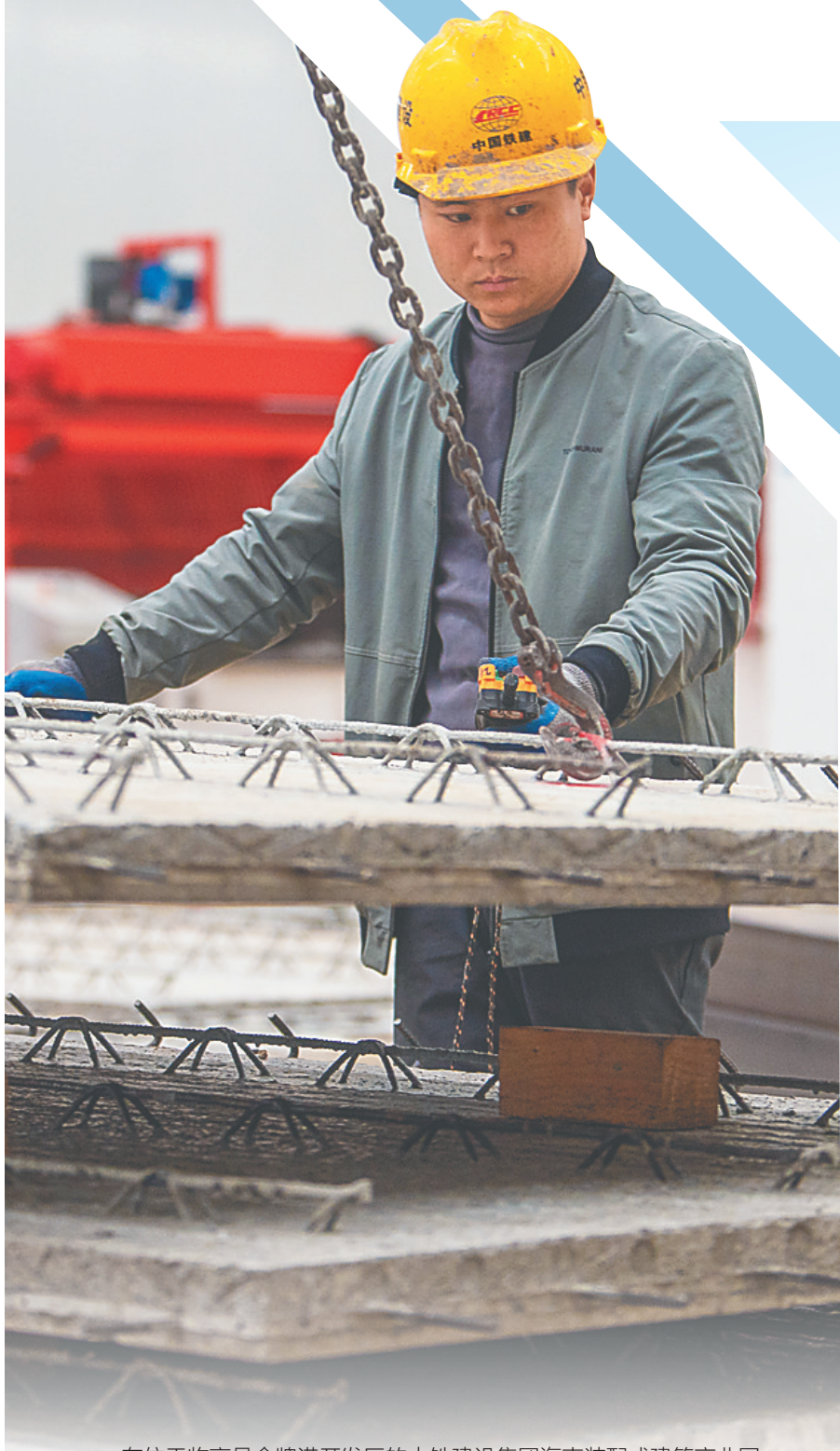
在位于临高县金牌港开发区的中铁建设集团海南装配式建筑产业园，刚生产的叠合板等运输车辆装载运往建筑工地。 本报记者 袁琛 摄
