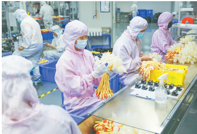
在海南维力医疗科技开发有限公司生产车间内,工人检查导尿管质量。 方山 摄
