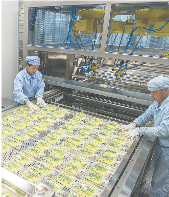
在海口国家高新区药谷工业园的海南爱科制药有限公司生产车间灭菌间,工作人员配合机械手分拣灌封好的产品。 阮琛 摄
