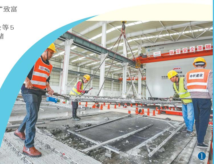
图① 位于临高县金牌港开发区的中铁建设海南绿色建筑产业园，工作人员生产用于装配式建筑的PC叠合板等材料。
