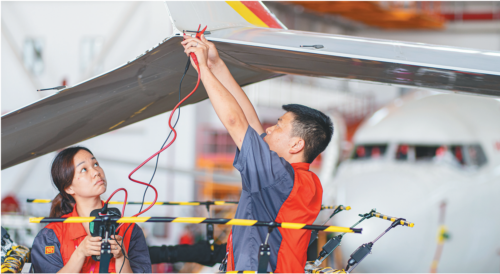
曾小清和杨德武执行飞机静电放电刷的测试检查。
