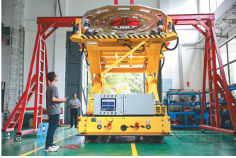
近日，工作人员在调试“中国天眼”馈源接收机拆装机器人。
