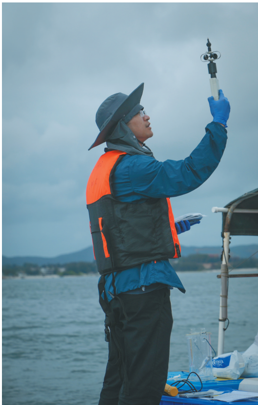
厦门大学近海海洋环境科学国家重点实验室副教授沈渊手持风速仪进行风速监测。风速是计算海洋向大气吸收或释放二氧化碳量的关键数据之一。
