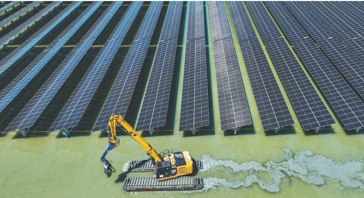
水陆两栖打桩机从一排排安装好的光伏板前经过。
