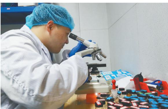
赵苗博士在上海光机所光学实验室内使用显微镜观察光盘材料切片。
