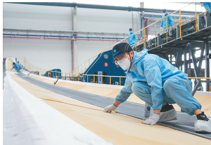
位于东方市的东方明阳新能源高端装备产业基地里，长143米、叶轮直径达292米的风电叶片在这里制造，是全球已下线叶轮直径最大的风电叶片。本报记者 武威 摄
