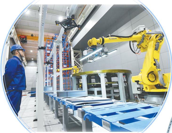
↑在哈电集团哈尔滨电机厂有限责任公司汽轮机智能叠片间，工作人员在观察智能设备运行情况。
