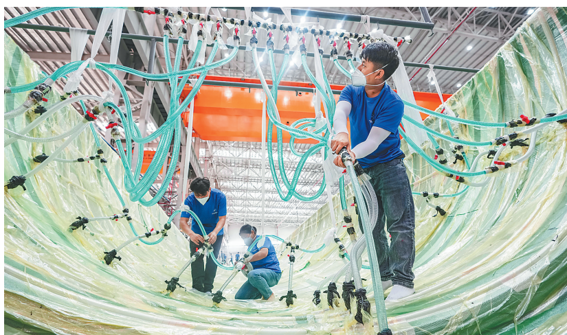
在东方明阳新能源高端装备产业基地，工作人员正在制造海上超大型风电叶片。 本报记者 陈元才 摄
