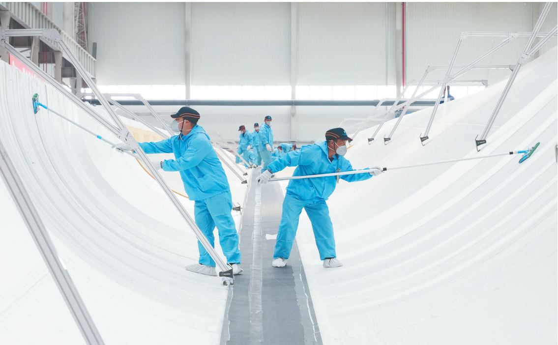
在东方明阳新能源高端装备制造产业基地，工作人员正在制造M5000海上超大型叶片。该叶片长118米，叶轮直径达260米，为全球已下线叶轮直径最大的风电叶片。本报记者 武威摄
