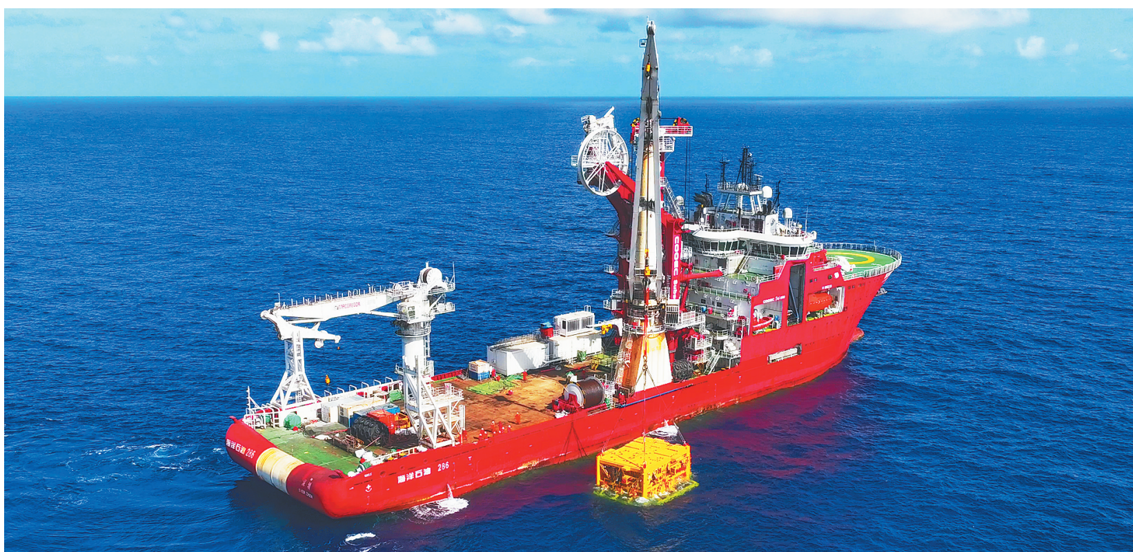
↑“深海一号”二期项目所用深水水下中心管汇入水瞬间。 →海上作业人员对即将实施水下安装作业的深水水下中心管汇进行检查。 温世航 檀晓光 摄
