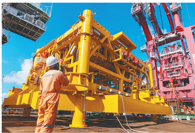
↑“深海一号”二期项目所用深水水下中心管汇入水瞬间。 →海上作业人员对即将实施水下安装作业的深水水下中心管汇进行检查。 温世航 檀晓光 摄
