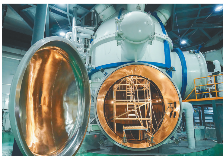
图为哈尔滨工业大学空间环境地面模拟装置月尘舱。 新华社发
