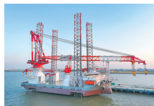
5月18日，由中铁大桥局和招商工业共同研制的最新一代2000吨自升式海上风电安装平台“大桥海风”号在江苏南通交付。“大桥海风”船长138米，船宽53米，拥有4根131米高的桩腿，多项性能指标达到国际领先水平。图为当日拍摄的“大桥海风”号。 新华社发
