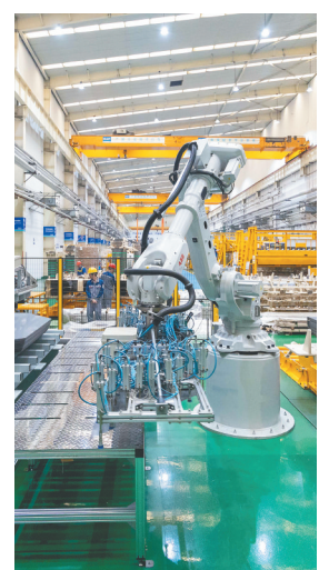
在位于长三角G60科创走廊策源地的上海松江，正泰电气变压器车间内的机器人把一层层薄为0.23毫米的硅钢片按设计要求叠装加工。 本栏图片均由新华社发
