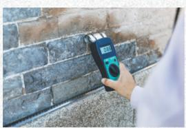
2023年7月14日，甘肃嘉峪关关城景区，文物保护工作者用设备测量城墙墙体酥碱部分的含水率和盐分。
