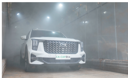
汽车在海南汽车试验场腐蚀试验室进行盐雾试验。 海南日报记者 陈若龙 摄
