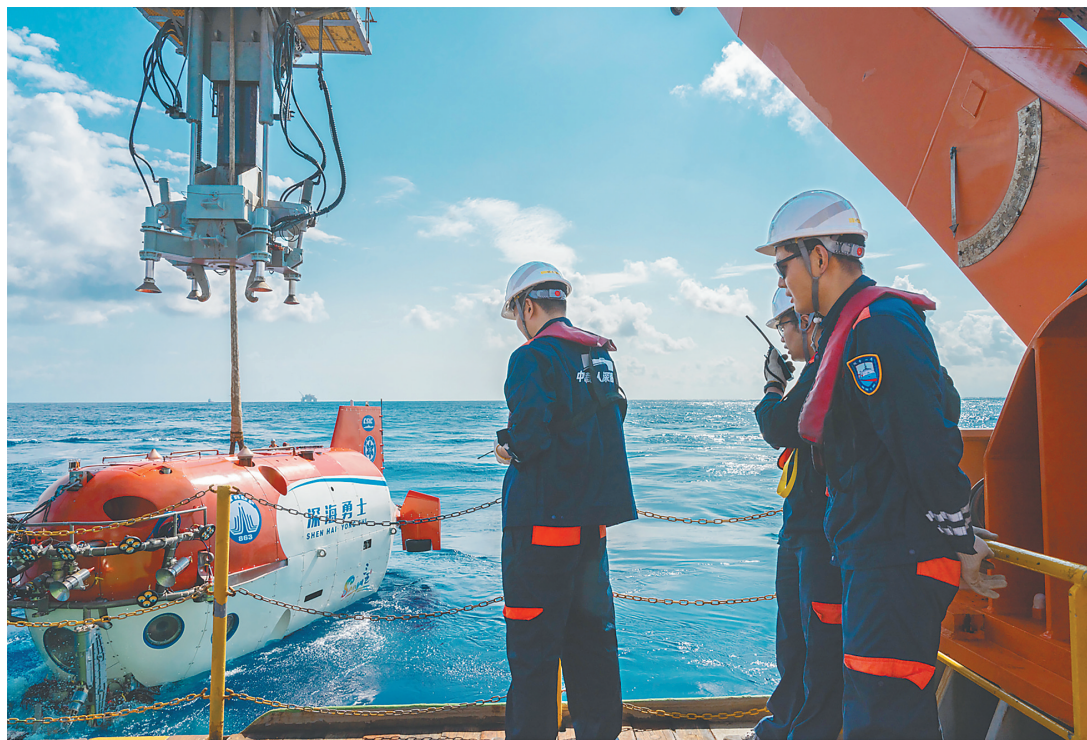
这是为深海考古进行的“深海勇士”号载人深潜器布放资料照片。
