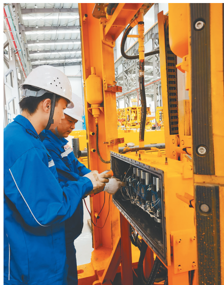
在海南龙盘油田科技有限公司组装车间内，工人对重型海床式静力触探系统进行组装。
