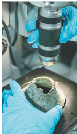
海南省博物馆的文物修复师用超景深显微镜观察铜铃表面纹饰及锈蚀物。 资料图
