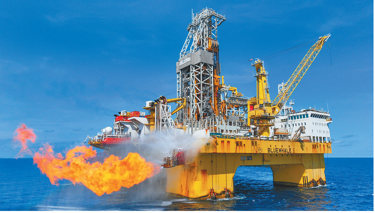
“深海一号”二期是我国首个深水高压气田项目,全面投产后将使“深海一号”整体产能提升超50%。图为“深海一号”二期深水气井测试放喷瞬间。中国海油供图
