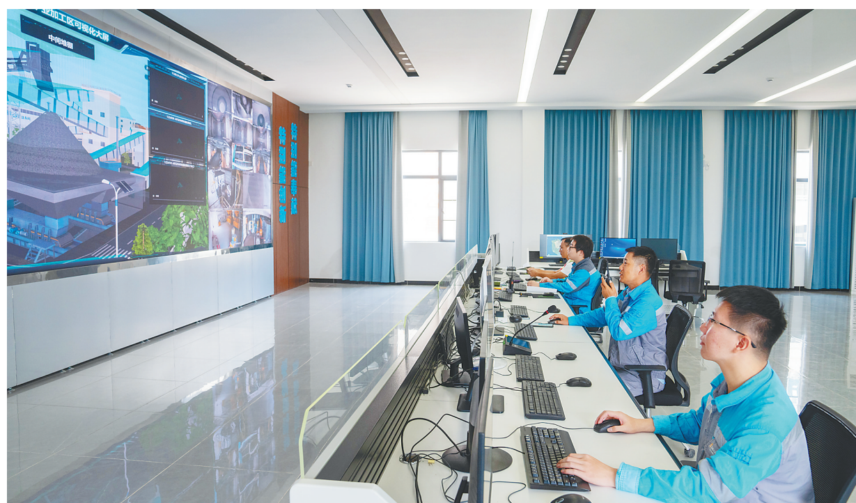
九定岭建筑用花岗岩骨料项目工作人员通过中央集控系统，实时监控矿山各类指标数据，远程操作自动化生产设备。海南日报全媒体记者 袁琛 摄
