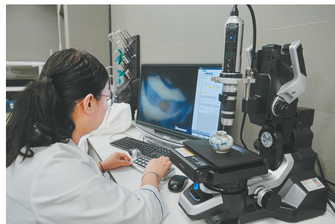
2023年8月17日,在中国(海南)南海博物馆深海文物保护实验室,工作人员李媛使用超景深显微镜观察明青花罐釉面的病害情况。
