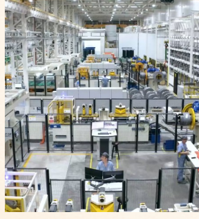
金盘科技海口数字化工厂核心车间全自动横剪叠码线。
