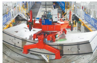
10月20日，我国自主研发的世界最大直径高铁盾构机“领航号”在沪渝蓉高铁崇太长江隧道掘进突破1000环。崇太长江隧道连接上海崇明和江苏太仓，全长14.25千米，建成后有望实现高铁过江不减速，对于推动长江经济带的发展具有重要意义。图为“领航号”盾构机进行管片吊装作业。新华社发
