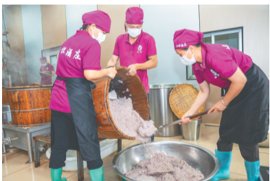
海南山栏酒庄工人正采取“三蒸两淋”工艺处理山栏米。
