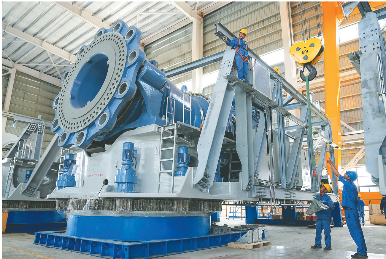
在海南洋浦海上风电产业园一期厂房，工程人员装配风机主机。海南日报全媒体记者 武威 摄
