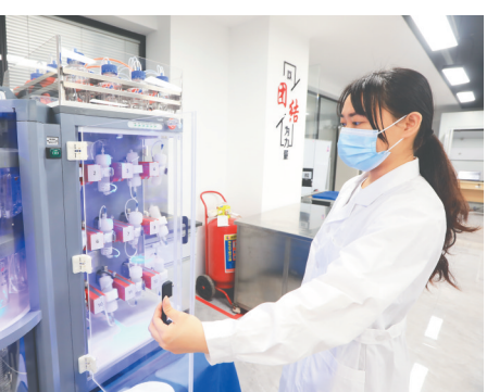
海南建邦制药科技有限公司研发人员正在测试一台多肽合成仪。通讯员 程守满 摄
