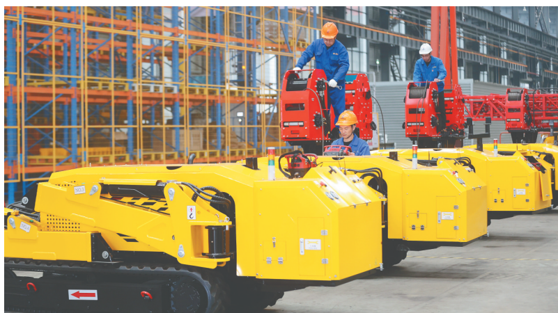
在位于浙江省湖州市德清县雷甸镇的浙江省建设工程机械集团有限公司德清精益智能工厂,工人赶制履带式轻型组塔装置产品。
