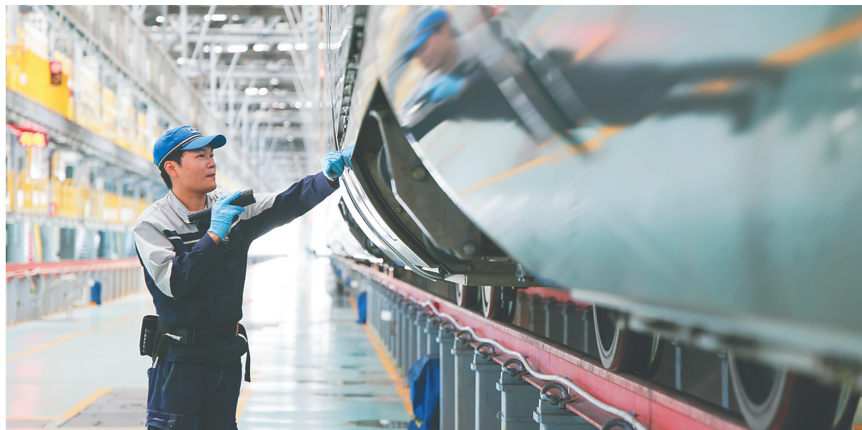
在广州动车段深圳动车运用所,检修人员检查“复兴号”智能动车组车外。
