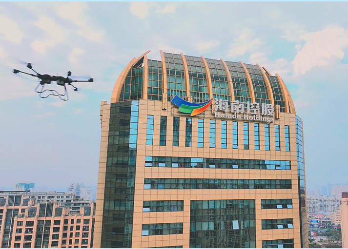
海南华铁50KG、100KG载重无人机已研发落地并开展多场景应用。
