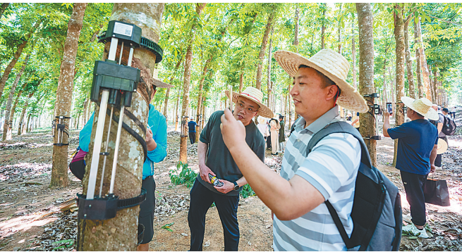
海南橡胶“一树机”割胶机器人正在割胶。海报集团全媒体中心记者 蒙美顺 摄
