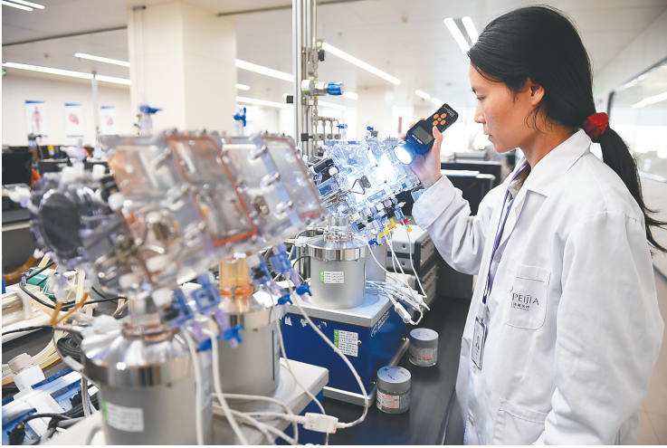
在位于苏州工业园区的沛嘉医疗科技(苏州)有限公司测试实验室里，检测人员使用频闪仪检查正在疲劳测试中的人工心脏瓣膜开闭合形态。本栏图片均由新华社发
