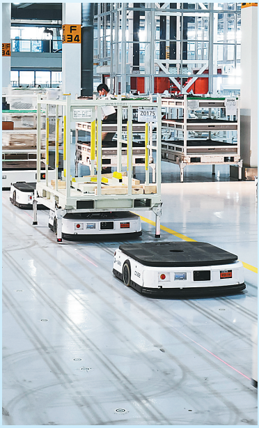
在位于吉林长春的一汽解放J7智能工厂内,AGV搬运机器人排队行驶在规划路线上。 新华社发
