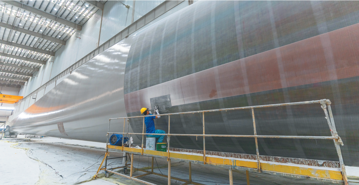
在明阳东方基地生产车间内,工人进行超大型叶片组装作业。 海南日报全媒体记者 袁琛 摄
