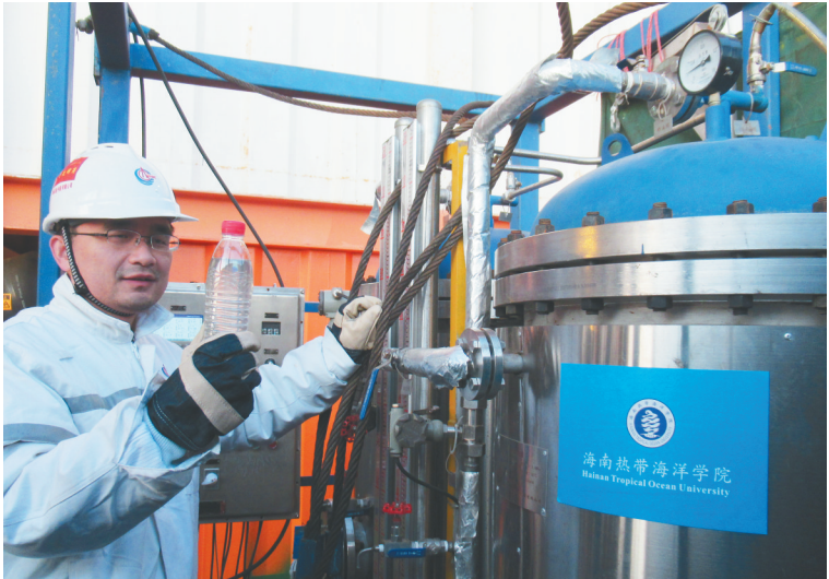
海南热带海洋学院万武波副教授在中海油金县1-1平台测试学校研发的油水分离装置。 本版图片均由海南热带海洋学院提供
