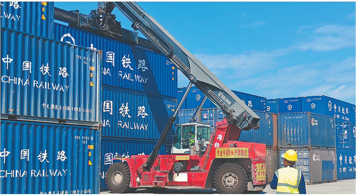
海口铁路货场内,正面吊正在进行集装箱装卸作业。陈素梅摄
